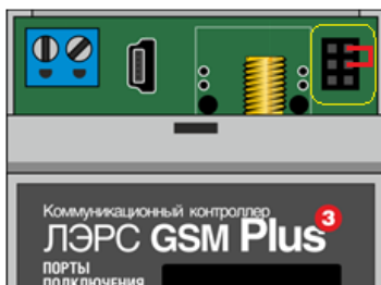
Рисунок 5.1 – Установка перемычки для обновления ПО
